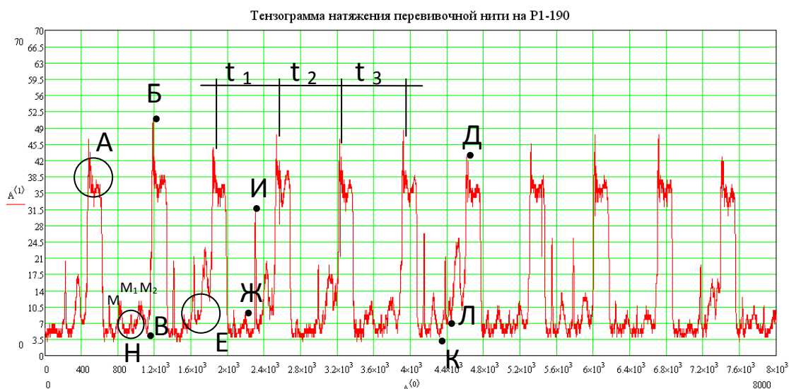
Рис. 5. Внешний вид тензограммы натяжения перевивочной нити на станке P1-190 (1)
