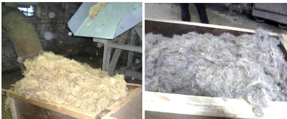
Рис. Линия, реализующая упрощенную технологию переработки льнотресты в однотипное волокно:
