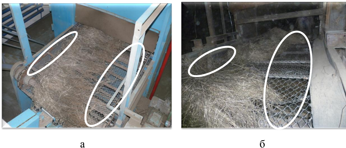
Рис. 1. Вид слоя льняной тресты на транспортёре сушильной машины а – в СКП-1-10ЛУ1 на льнозаводе в Республике Татарстан; б – в СКП-9-7ЛМ на льнозаводе в Костромской области
